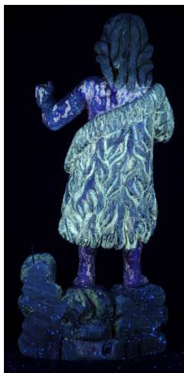
Figura 51. Fotografias com Fluorescência ao Ultravioleta: áreas na cor violeta mostram locais onde foi realizada reintegração cromática e apresentação estética.
