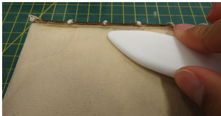
Figura 89: Bifólio colado na área de encaixe da encadernação.
