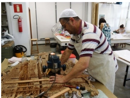
Figura 27 - Abertura dos sulcos perpendiculares as fibras do lenho (Fotos : Jussara)
