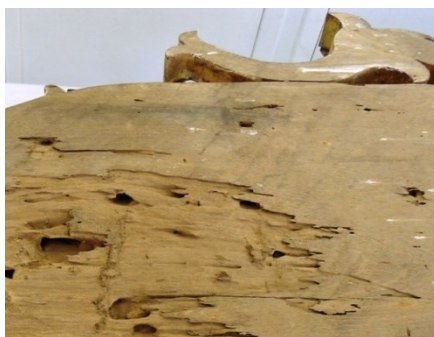
Figura 10 – Marcas de plaina manual. (Foto : Ruy Caldeira)
