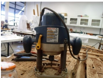
Figura 26 - Tupia-RYOBİ® RE 180PL 127 v. equipada com bit fresa de 10 mm. (Fotos : Ruy Caldeira)
