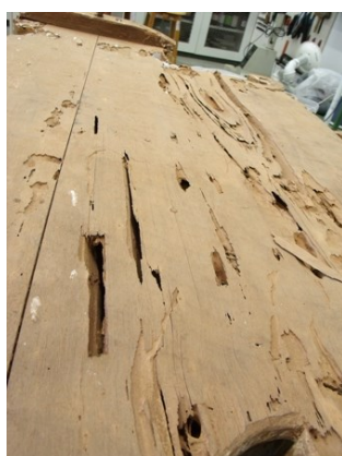
Figuras 17 e 18 – Diferenças de ataque nas áreas de cerne e alburno (Fotos : Ruy Caldeira)
