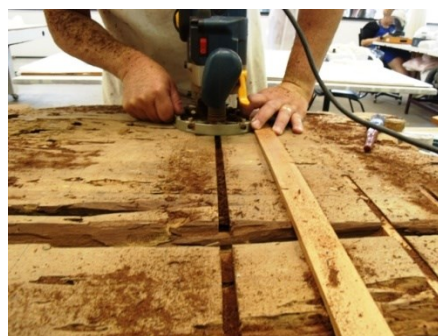
Figura 27 - Abertura dos sulcos perpendiculares as fibras do lenho (Fotos : Jussara)
