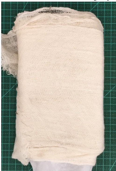
Figura 35 — Volume envolvido em bandagem para secagem
