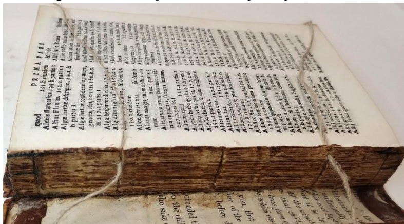
Figura 31 — Inserção de cordões para apoio da costura
