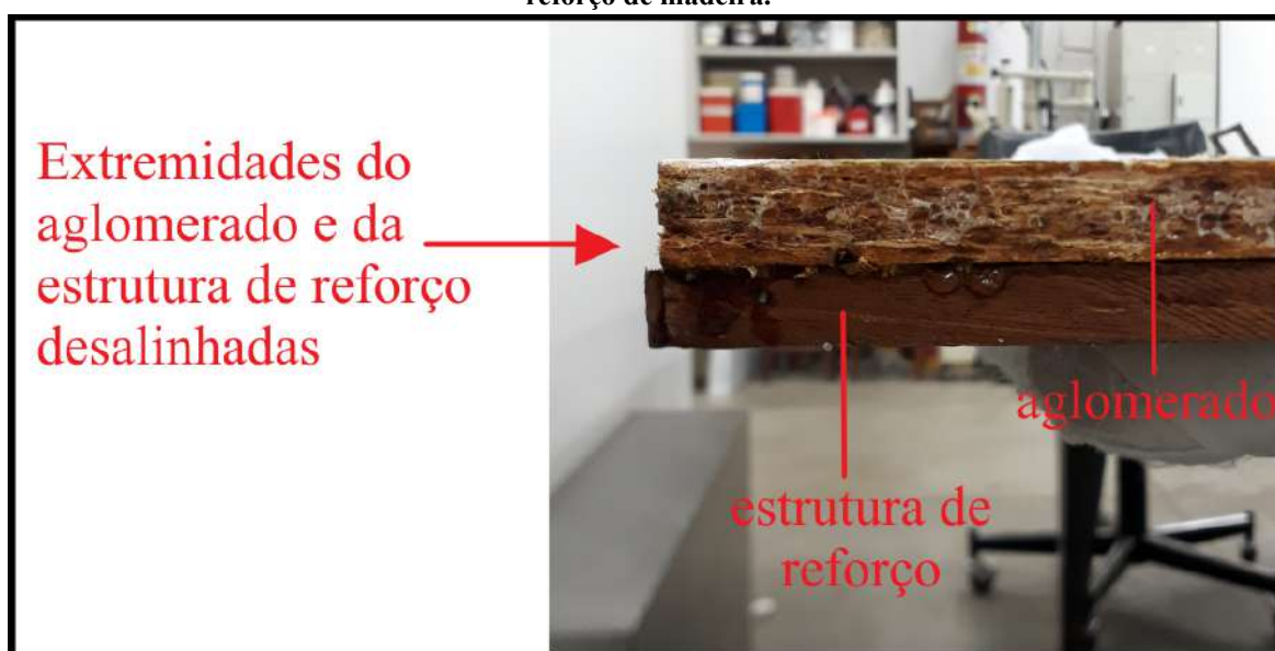
Figura 42 - Aresta direita superior apresentando desnivelamento entre o aglomerado e a estrutura de reforço de madeira.
