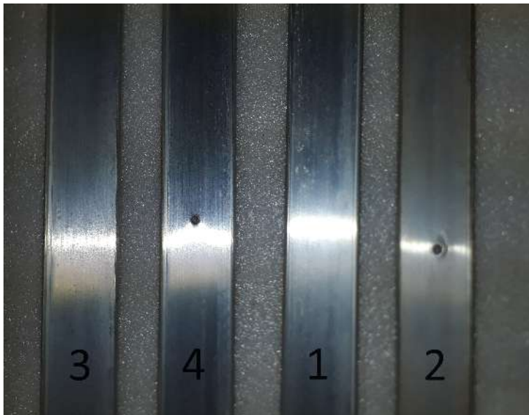
Figura 34 - Da esquerda para a direita: palhetas n° 3, 4, 1 e 2 após a limpeza química com swab e amônia a 10%.
