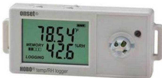
Figura 27 - Modelo de aparelho que possui as funções de termo-higrômetro e datalogger
