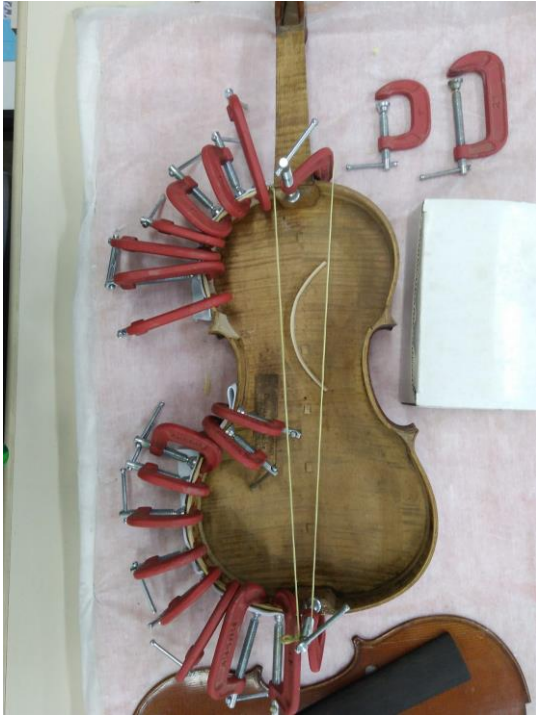
Figura 85- Intervenções realizadas: Colagem do reforço de borda e dos blocos superior e inferior. Fotografia: Laura Fiorini
