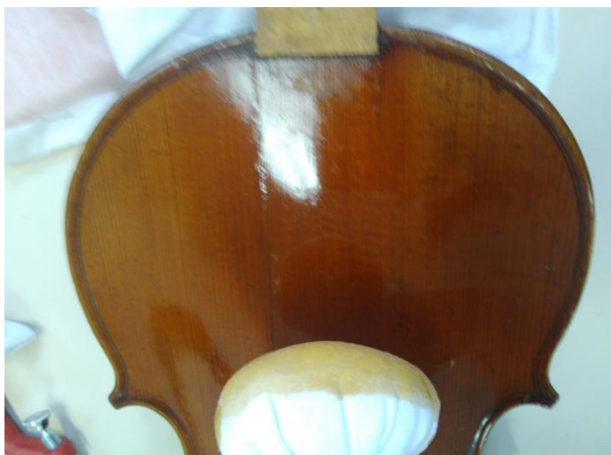
Figura 110- Intervenções realizadas: Aplicação da boneca embebida em verniz e óleo de linhaça para realizar o polimento. Fotografia: Laura Fiorini
