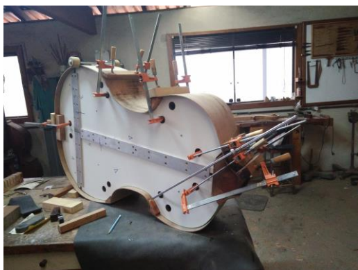
Figura 13- Técnica construtiva: finalização da colagem das laterais. Fotografia: Laura Fiorini
