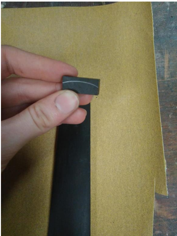
Figura 74- Intervenções realizadas: Marcação da curva do espelho com grafite na pestana superior. Fotografia: Laura Fiorini
