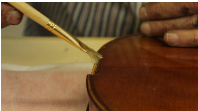
Figura 99- Intervenção realizadas: Aplicação de cola de boi na sessão do corpo onde a pestana inferior se insere. Fotografia: Laura Fiorini
