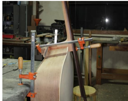
Figura 25 Técnica construtiva: Colagem do braço. Fotografia: Laura Fiorini
