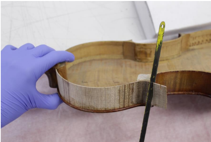
Figura 84 -Intervenções realizadas: Retirada de sobra de madeira da lateral superior direita. Fotografia: Laura Fiorini
