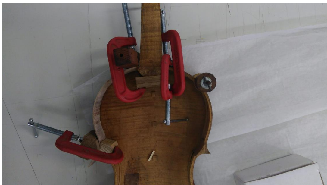
Figura 81 -Intervenções realizadas. Colagem da lateral superior no bloco estrutural do braço. Fotografia: Laura Fiorini
