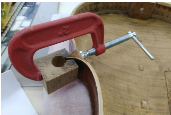
Figura 89- Intervenções realizadas: Colagem da junção das laterais nas áreas dos "C's". Fotografia: Laura Fiorini
