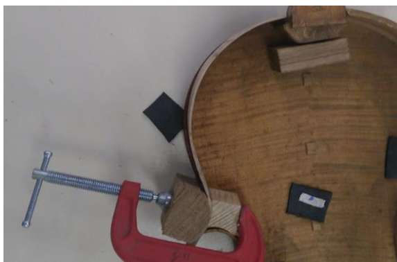
Figura 80 -Intervenções realizadas: Modelagem da curva da lateral superior direita. Fotografia: Laura Fiorini
