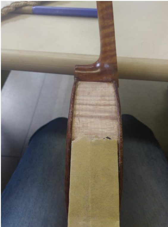
Figura 132- Intervenções realizadas: Lixamento com lixa gramatura 280 da lateral superior direita. Fotografia: Laura Fiorini
