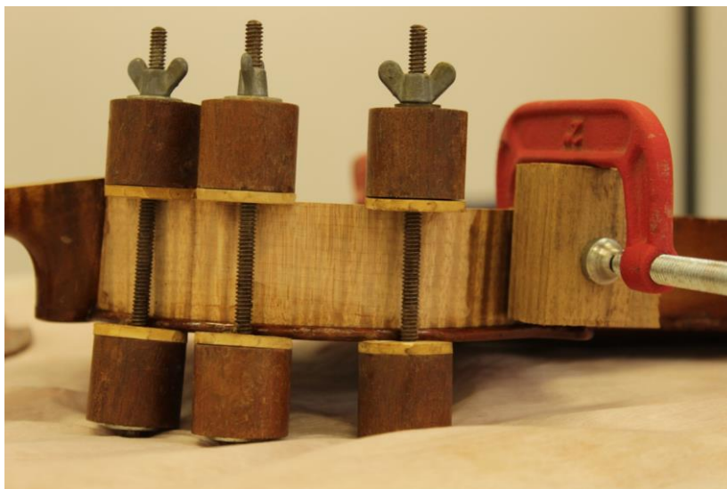
Figura 82- Intervenções realizadas: Colagem da lateral superior direita no fundo e no bloco estrutural. Fotografia: Laura Fiorini
