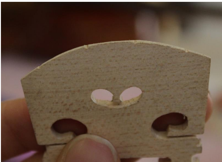
Figura 125 Intervenções realizadas: Resultado da feitura dos sulcos para assentar as cordas na crista do cavalete. Fotografia: Laura Fiorini
