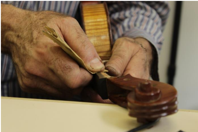
Figura 128- Intervenções realizadas: Acabamento da lateral do espelho com lixa gramatura 600. Fotografia: Laura Fiorini
