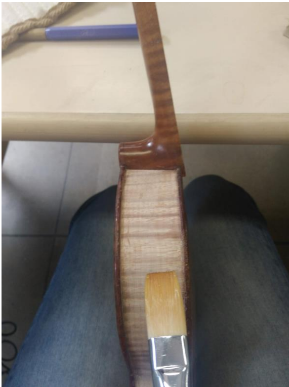
Figura 133- Intervenções realizadas: Aplicação da primeira camada de verniz para impermeabilizar a madeira. Fotografia: Laura Fiorini
