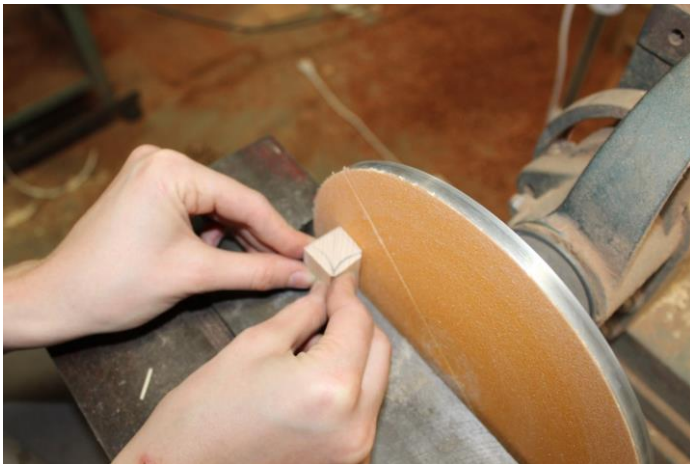
Figura 64- Intervenções realizadas: Lixamento do bloco para esquadrear os planos. Fotografia: Laura Fiorini
