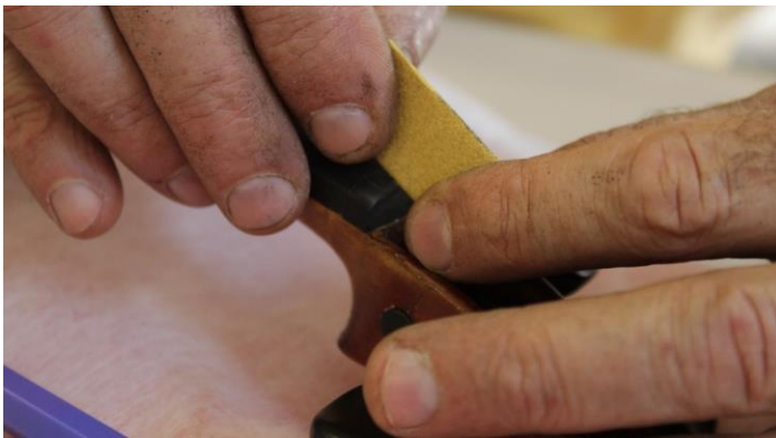
Figura 115-Intervenções realizadas: Acabamento dos sulcos para as cordas na pestana superior com lixa gramatura 220. Fotografia: Laura Fiorini
