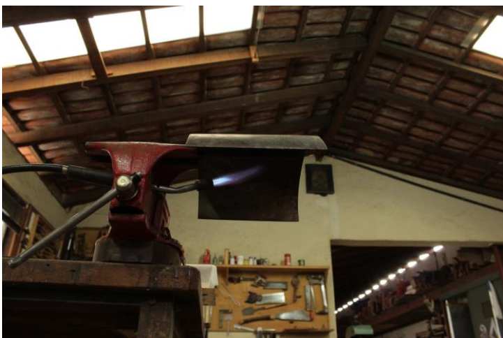
Figura 70 -Intervenções realizadas: Sistema de maçarico e chapa de metal preso a uma morsa para modelar madeira. Fotografia: Laura Fiorini
