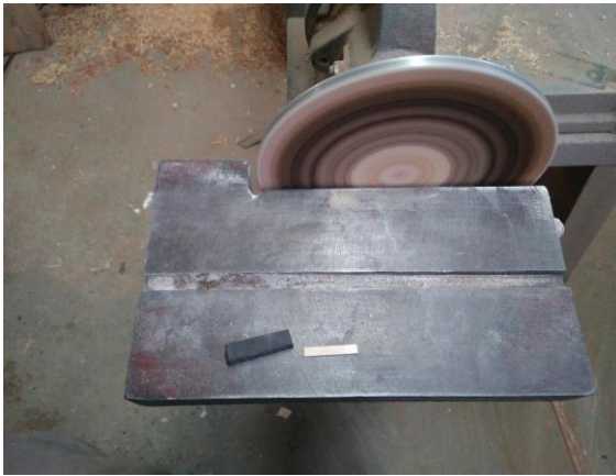
Figura 72- Intervenções realizadas: Pedaco de Ébano e molde de madeira da pestana sobre a lixadeira elétrica. Fotografia: Laura Fiorini
