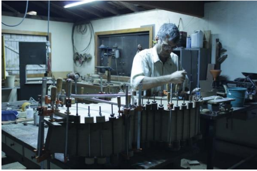
Figura 15- Técnica construtiva: Colagem do fundo. Fotografia: Laura Fiorini
