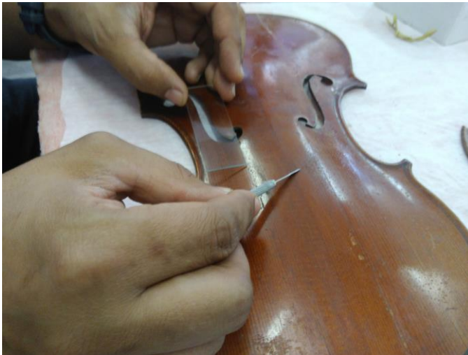
Figura 52- Estado de conservação: Área de coleta para o exame do material incrustado no tampo. Fotografia: Laura Fiorini
