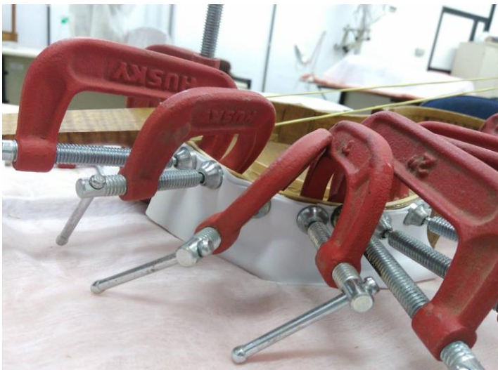
Figura 86 -Intervenções realizadas: Colagem do reforço de borda. Fotografia: Laura Fiorini
