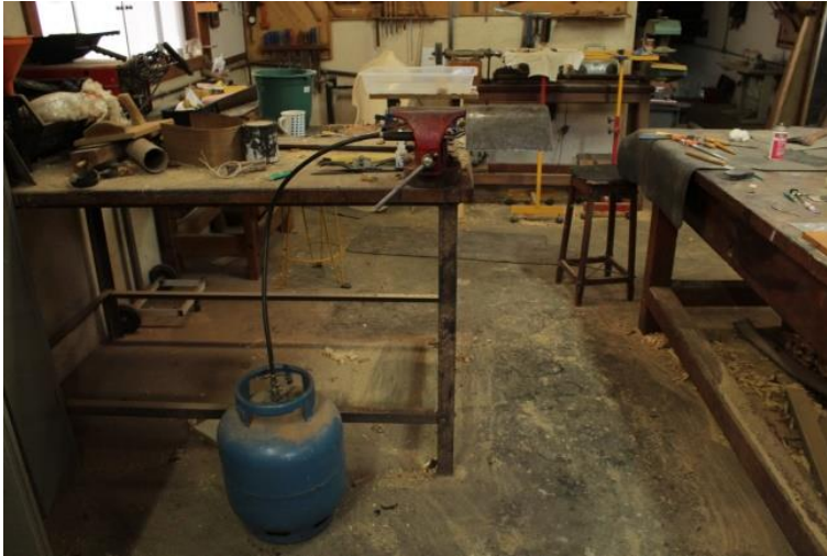
Figura 71- Intervenções realizadas: Sistema de maçarico e chapa de metal preso a uma morsa para modelar madeira. Fotografia: Laura Fiorini
