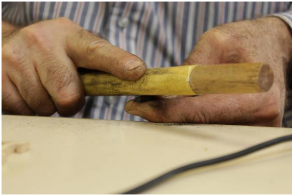
Figura 75- Intervenções realizadas: Escultura da pestana inferior sendo feita com o bloco de lixa redondo. Fotografia: Laura Fiorini
