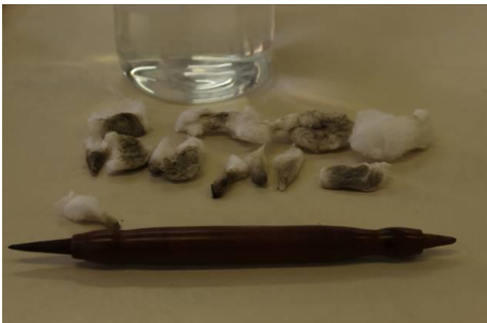
Figura 55 Intervenções realizadas: Limpeza química com swab nas áreas impregnadas com fita adesiva. Fotografia: Laura Fiorini
