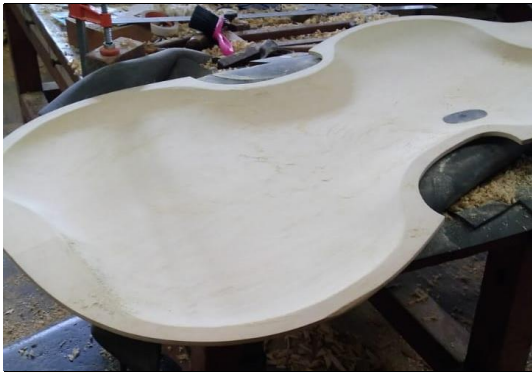
Figura 19- Técnica construtiva: Acabamento interno do tampo feito com raspadeira. Fotografia: Laura Fiorini.
