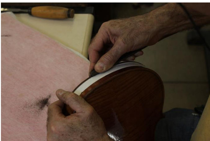
Figura 116- Intervenções realizadas: Colocação de fita crepe para proteção do verniz da lateral durante o procedimento de calibragem da pestana inferior. Fotografia: Laura Fiorini
