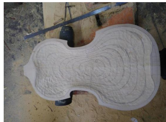
Figura 18- Técnica construtiva: Linhas de calibragem de espessura do tampo. Fotografia: Laura Fiorini
