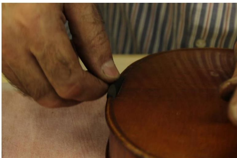
Figura 101 -Intervenções realizadas: Colagem da pestana inferior, estabilizando a peça apenas com a pressão dos dedos. Fotografia: Laura Fiorini
