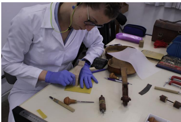
Figura 79- Intervenções realizadas: Calibragem da lateral superior direita. Fotografia: Laura Fiorini
