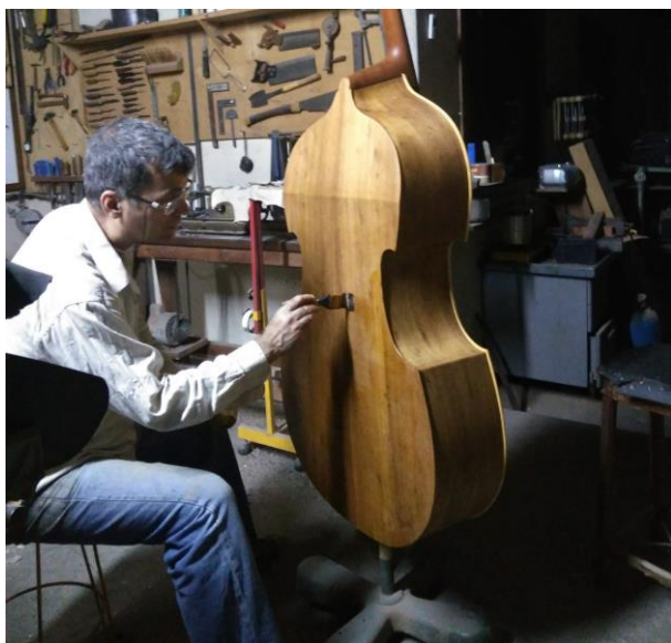
Figura 29- Técnica construtiva: Configuração espacial para envernizar. Fotografia: Laura Fiorini.
