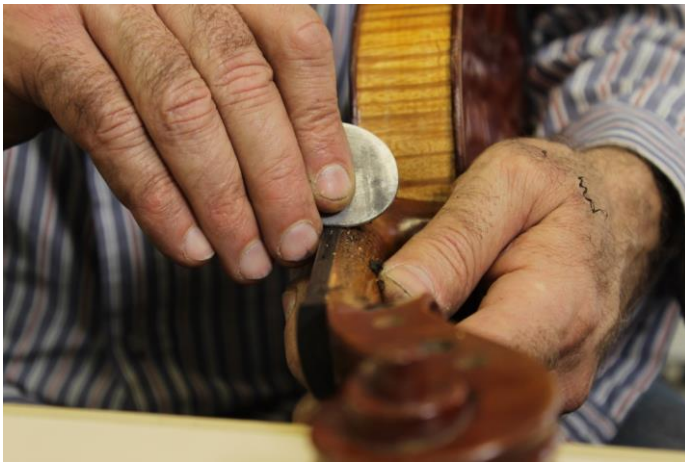
Figura 126 -Intervenções realizadas: Raspagem da lateral do espelho. Fotografia: Laura Fiorini
