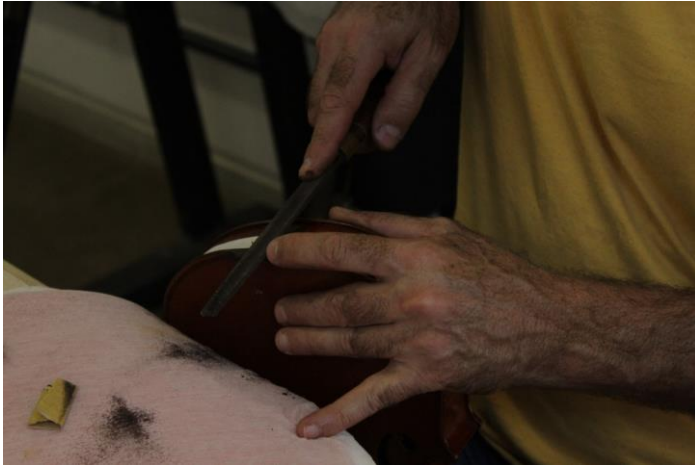
Figura 117- Intervenções realizadas: Calibragem da altura e curvatura da pestana inferior. Fotografia: Laura Fiorini
