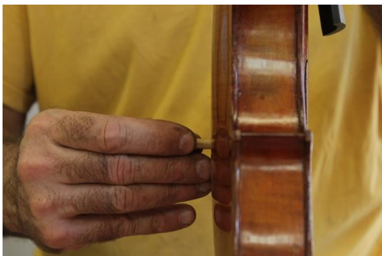
Figura 130 -Intervenções realizadas: Medição do tamanho da alma em relação ao volume do corpo. Fotografia: Laura Fiorini
