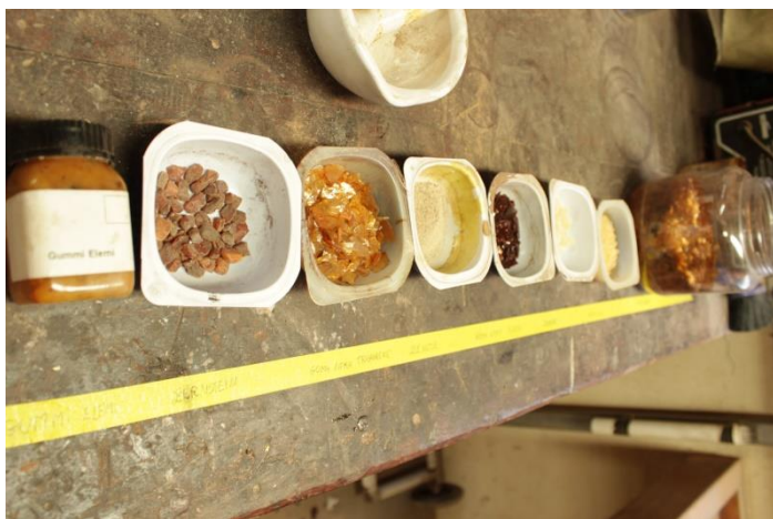
Figura 105 -Seleção das resinas para preparação o verniz. Da esquerda para direita estão: gummi elemei, âmbar, goma laca transparente, benzoe, goma laca rubi, damar, mastique, goma laca. Fotografia: Laura Fiorini.
