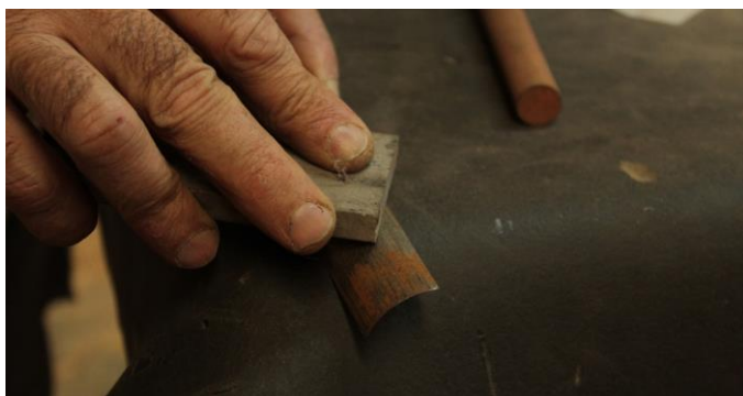
Figura 66- Intervenções realizadas: Afição de uma goiva para esculpir o bloco estrutural. Fotografia: Laura Fiorini
