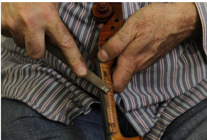
Figura 127- Intervenções realizadas: Retífica com lima da lateral do espelho. Fotografia: Laura Fiorini
