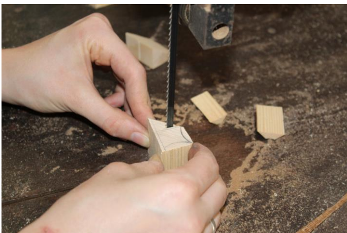
Figura 65 -Intervenções realizadas: Retirada do excesso de madeira com serra de fita. Fotografia: Laura Fiorini
