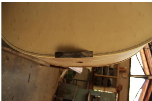
Figura 27- Técnica construtiva: Colocação da pestana inferior. Fotografia: Laura Fiorini
