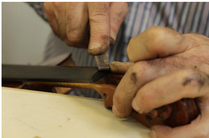
Figura 112- Intervenções realizadas: Calibragem de altura da pestana superior. Fotografia: Laura Fiorini
