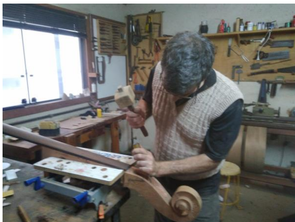
Figura 22- Técnica construtiva: cravelheiro em processo. Fotografia: Laura Fiorini
