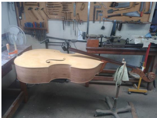
Figura 28- Técnica construtiva: Configuração espacial para envernizar. Fotografia: Laura Fiorini.
