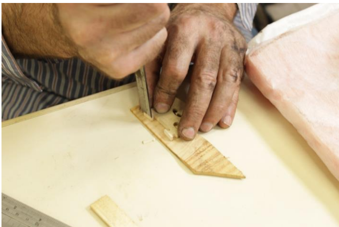
Figura 121- Intervenções realizadas: Corte com formão do excesso de madeira da base do cavalete. Fotografia: Laura Fiorini
