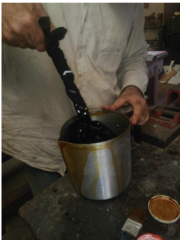
Figura 107 -Filtragem do verniz com malha de algodão. Fotografia: Laura Fiorini.
