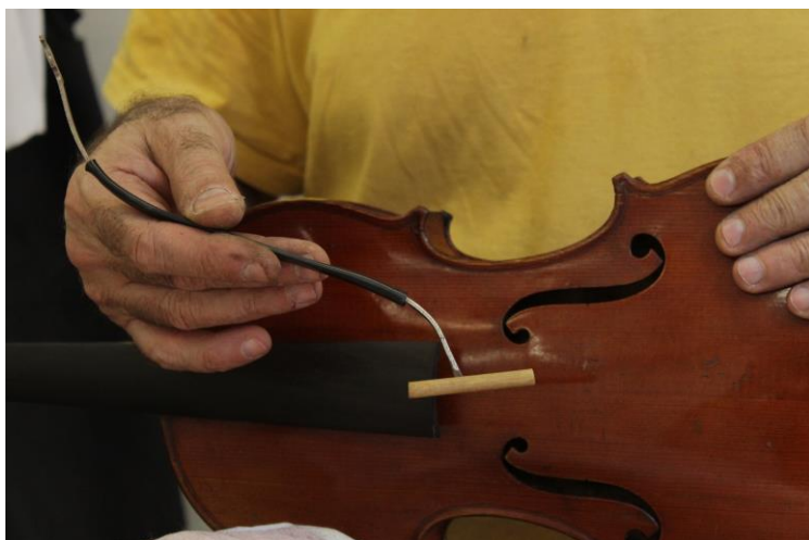
Figura 136- Montagem: Colocação da alma utilizando o ferro de alma. Fotografia: Laura Fiorini
