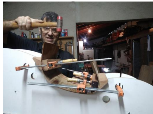
Figura 12- Técnica construtiva: Colagem da lateral "C" nos blocos estruturais. Fotografia: Laura Fiorini
