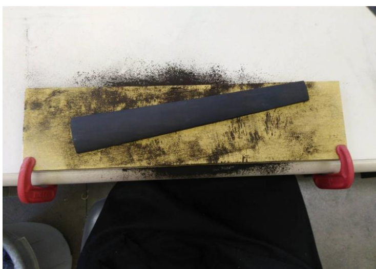
Figura 96- Intervenções realizadas: Retificação da parte anterior do espelho utilizando o bloco de lixa gramatura 120. Fotografia: Laura Fiorini
