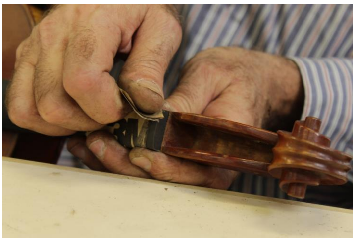
Figura 113- Intervenções realizadas: Acabamento da pestana superior com lixa de gramatura 600. Fotografia: Laura Fiorini
