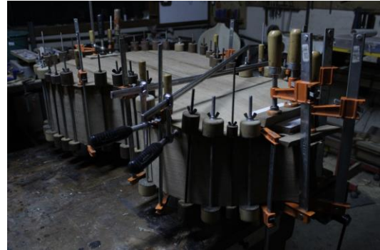
Figura 16- Técnica construtiva: Colagem do fundo. Fotografia: Laura Fiorini
