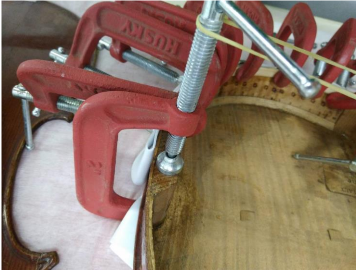
Figura 87 -Intervenções realizadas: Colagem do bloco estrutural inferior e do reforço de borda. Fotografia: Laura Fiorini
