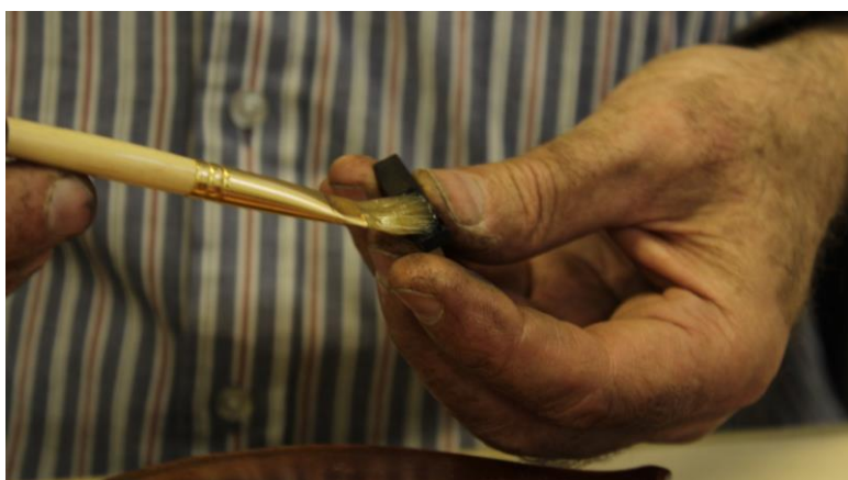
Figura 100 -Intervenção realizadas: Aplicação de cola de boi na pestana inferior. Fotografia: Laura Fiorini
