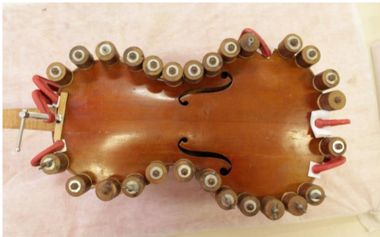
Figura 92 -Intervenções realizadas: Visão frontal da colagem do tampo com o corpo. Fotografia: Laura Fiorini
