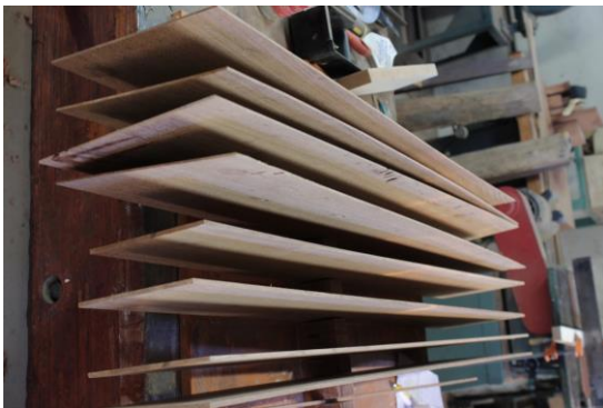
Figura 11- Técnica construtiva: lâminas de madeira selecionadas para as laterais (já esquadrejadas e calibradas) antes de serem dobradas. Fotografia: Laura Fiorini
