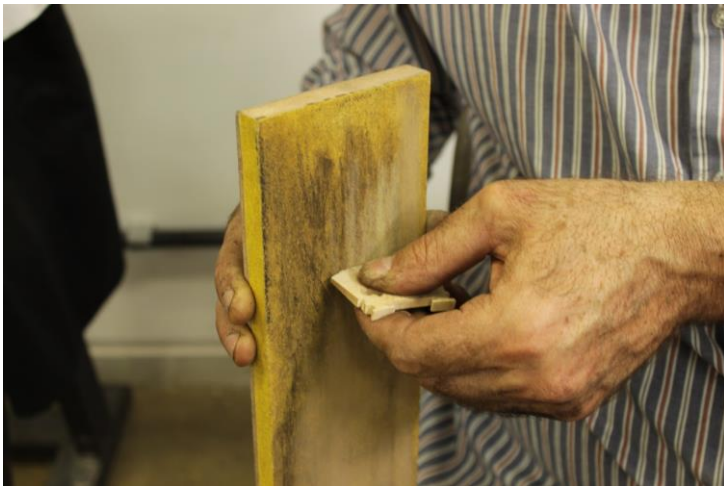
Figura 124- Intervenções realizadas: Calibragem da curva da crista do cavalete de acordo com a curva previamente desenhada. Fotografia: Laura Fiorini
