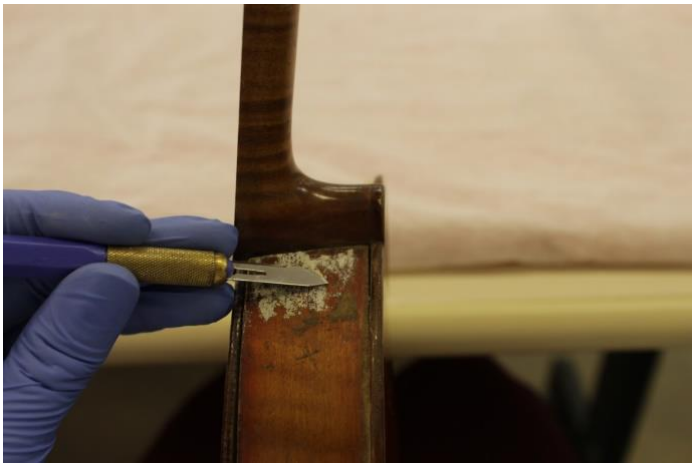
Figura 54 Intervenções realizadas: Limpeza mecânica com bisturi nas áreas impregnadas com fita adesiva. Fotografia: Laura Fiorini
