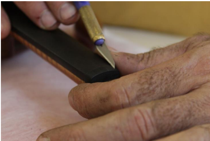
Figura 114- Intervenções realizadas: Criação dos sulcos para as cordas na pestana superior. Fotografia: Laura Fiorini
