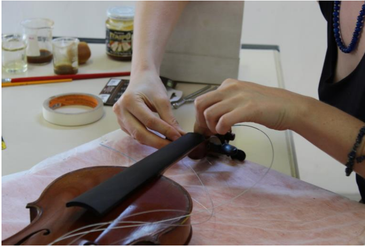
Figura 139- Montagem: Inserção da corda na cravelha. Fotografia: Laura Fiorini
