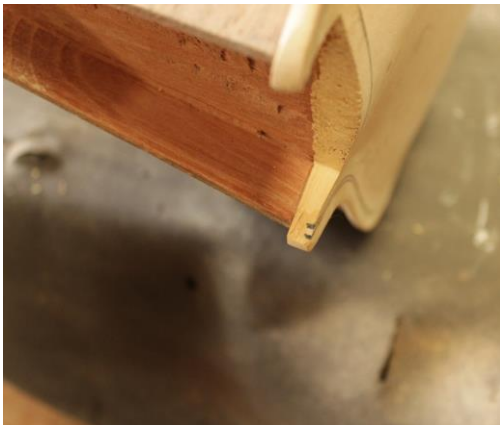
Figura 24- Técnica construtiva: Definição do comprimento de corda através do encastro do braço. Fotografia: Laura Fiorini
