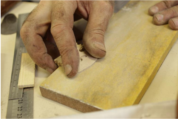
Figura 119 -Intervenções realizadas: Retifica da fase inferior do cavalete. Fotografia: Laura Fiorini
