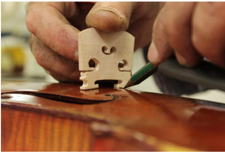
Figura 120- Intervenções realizadas: Marcação da base do cavalete de acordo com a curvatura do tampo. Fotografia: Laura Fiorini
