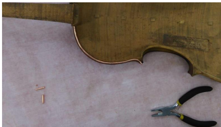
Figura 67- Intervenções realizadas: Feitura do molde da lateral superior direita. Fotografia: Laura Fiorini
