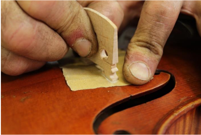
Figura 122 -Intervenções realizadas: Finalização da calibragem da base do cavalete utilizando o próprio tampo como base para o lixamento com lixa gramatura 220. Fotografia: Laura Fiorini
