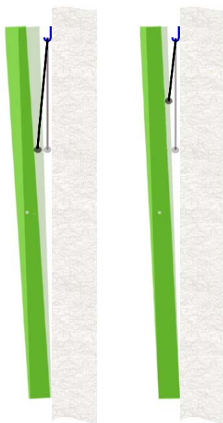
Figura 37 - Moldura rotaciona pelo posicionamento inadequado do sistema de fixação
