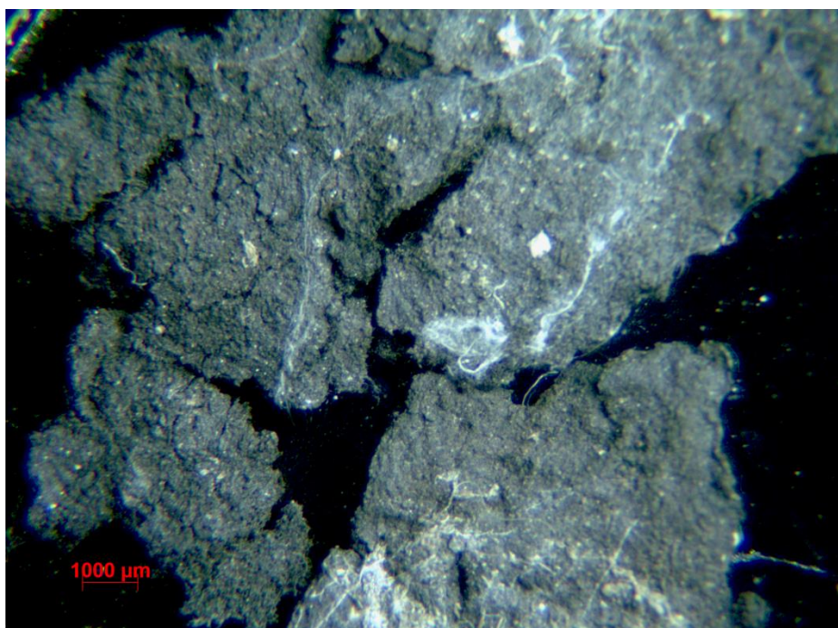
Figura 4- Am 3428T-Fragmentos referentes a matéria orgânica presa à pedra - verso - visto sob microscópio estereoscópico aumento 6.7X
