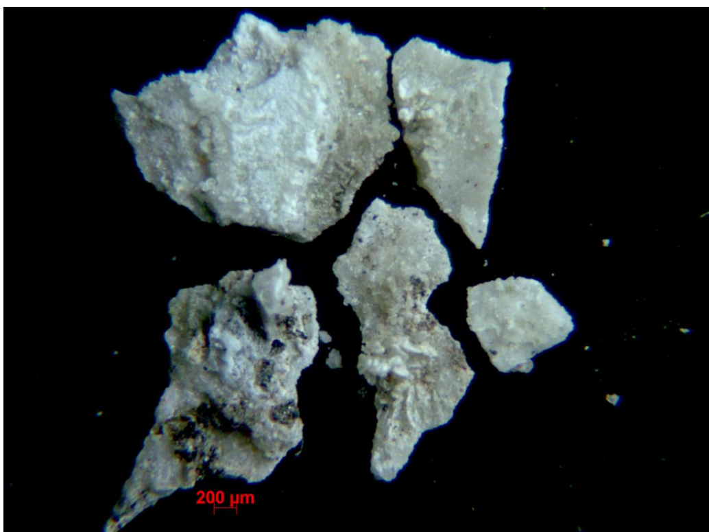
Figura 6- Am3429T-Fragmentos referentes a crosta encontrada em locais de escoamento de água. Retirados da lateral esquerda do brasão de Minas Gerais.Vista do verso-Visto sob o microscópio estereoscópico-aumento 20x
