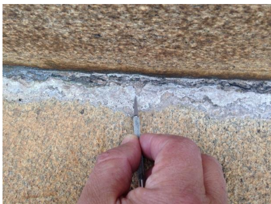
Figura 42: Coleta da AMOSTRA 3429T002 em local de incrustação.
