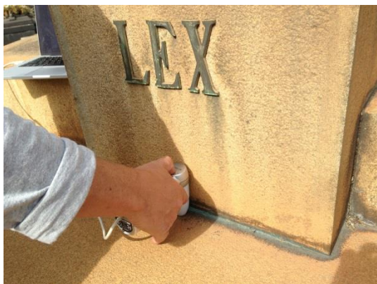
Figura 43: Fotografia de microscópio em local com incrustação de coloração esverdeada
