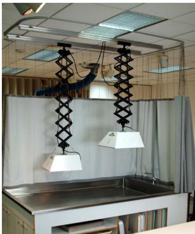
Figura 9 - Estrutura usada para clareamento de luz artificial com lâmpadas de iodetos metálicos no laboratório de conservação de papel do Museu de Belas Artes de São Francisco. (2002)
