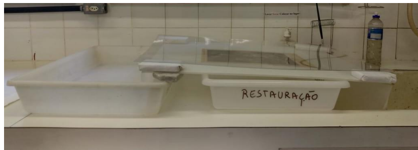
Figura 30 - Estrutura criada para o tratamento de capilaridade por Paraprint.
