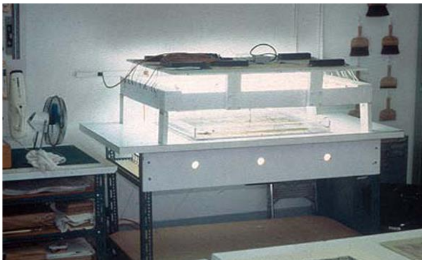
Figura 7 - Estrutura de clareamento artificial dupla face, desenvolvida na década de 80 no Cooperstown Graduate Program, com a participação de Cathleen Baker.
