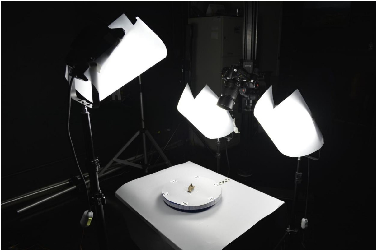
Figura 13: Setup com câmera posicionada a 60° em relação ao objeto. Fonte: Gilson Camilo
