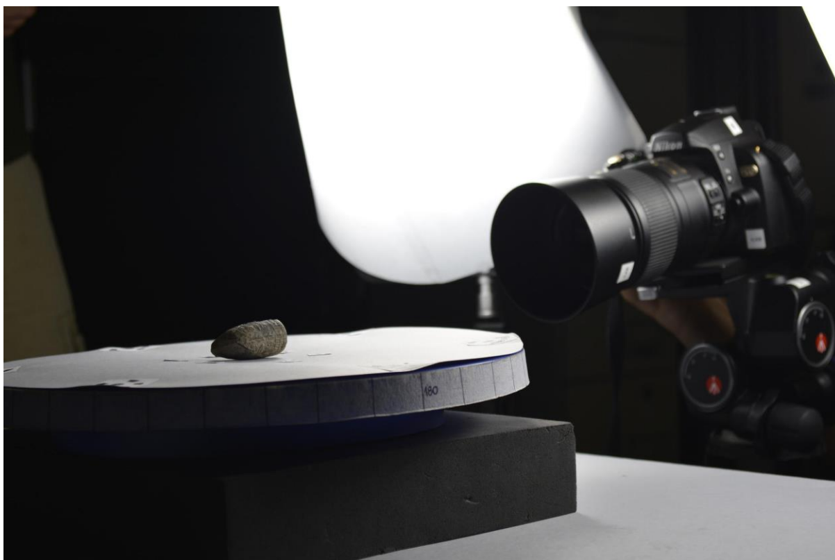
Figura 15: Setup com câmera posicionada a 10° em relação ao objeto. Fonte: Gilson Camilo.
