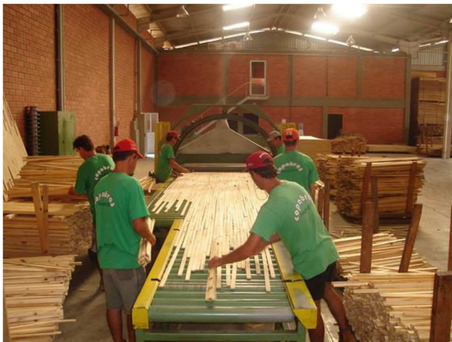
Figura 12 - fabricação do compensado sarrafeado. disponível em: https://woodtechnology.webnode.com.br/ acesso em: 08/10/2019.
