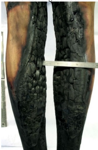
Figura 21 – A madeira destruída especialmente nas pernas. Carvão com ruptura transversal típica, em cubos e fendas longitudinais.
