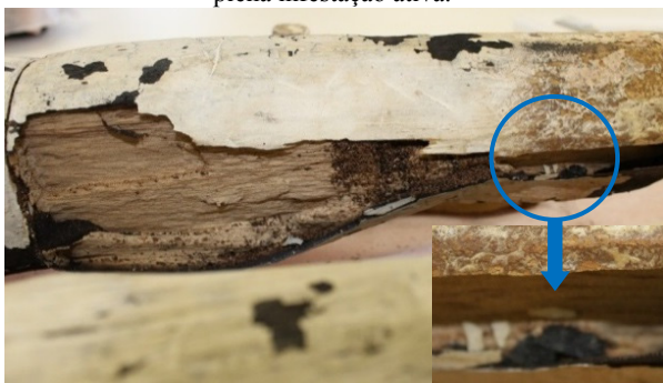
Fotografia 86 – Detalhe da perna esquerda com cupim em plena infestação ativa.
