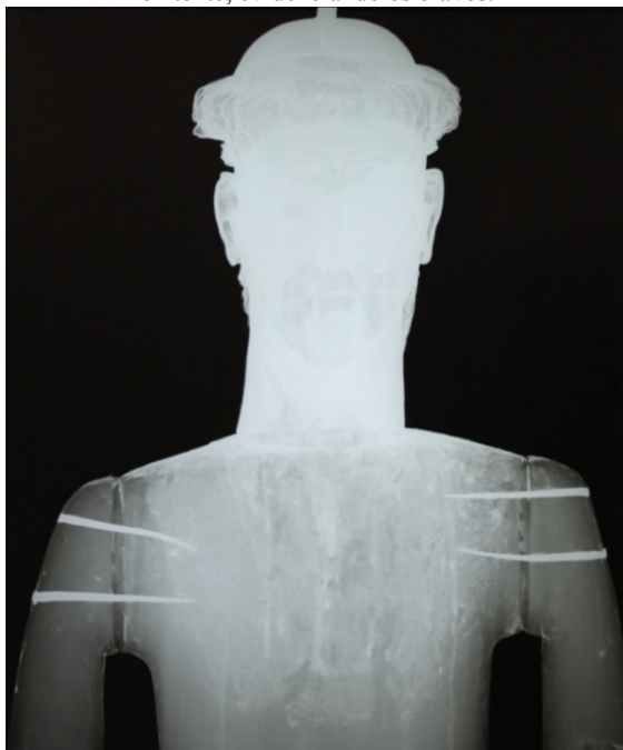
Imagem 10 – Radiografia- X de São Francisco de Assis Penitente, evidenciando os cravos.
