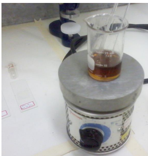
Figura 33 - Resina termoplástica para dispersão sobre a placa de aquecimento - Lacicor. Foto: Rita Cavalcante, 13 out 2016.
