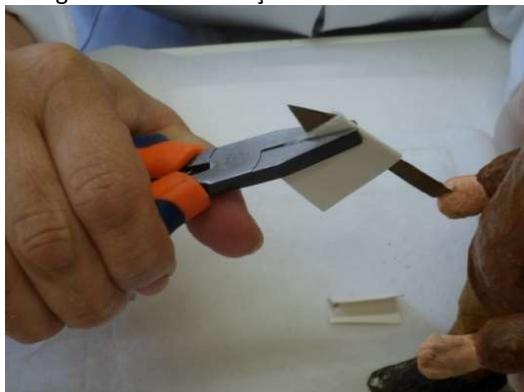
Fotografia 89- Planificação do metal com alicate.
