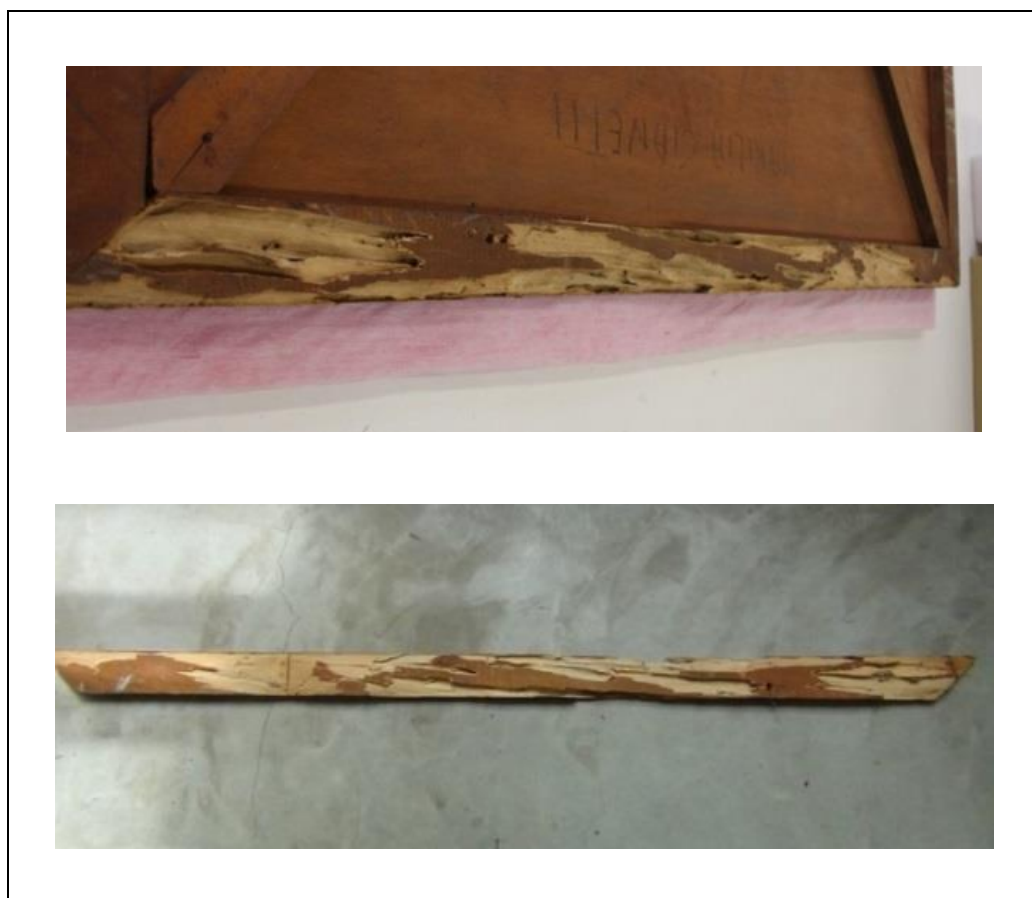
Figura 18— Peça estruturante com perdas de suporte devido ao ataque de cupins.
