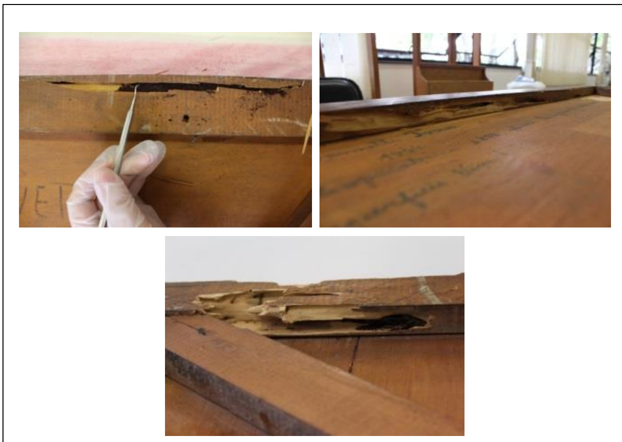
Figura 38 - Abertura das galerias das peças estruturantes da obra.
