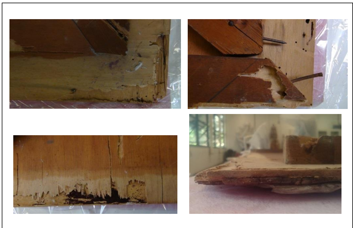
Figura 21– Perdas no suporte devido ao ataque de cupins.
