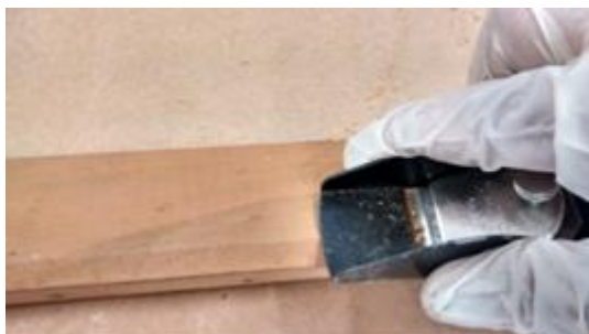
Figura 34: Planificação da madeira - Foto: Iamanda Riehl
