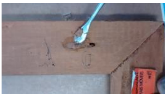
Figura 35: Preenchimento das perfurações - Foto: Iamanda Riehl
