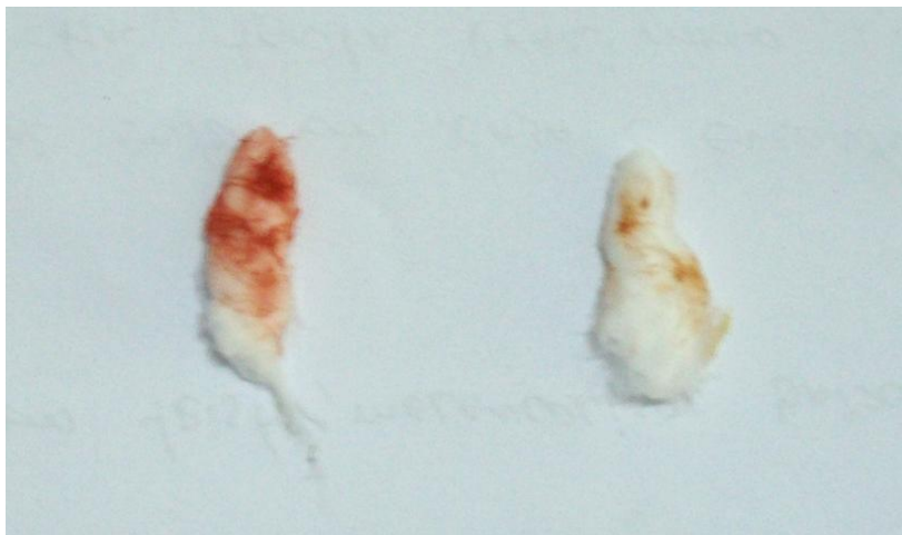
Figura 33 - Remoção de pigmentos com o solvente Isoctano. Fotos: Cybele Nascimento, 2015.
