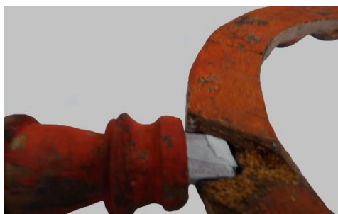
Figura 53 - Detalhe do processo de nova consolidação do aro, massa de serragem e envelopamento do encaixe da coluna. Foto: Ana Lucia Rodrigues (2015).
