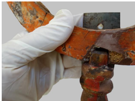
Figura 52 - Encaixe resina epóxi rompido. Foto: Ana Lucia Rodrigues (2014).
