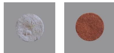
Figura 28: Protótipos de fibra de celulose e serragem para testes. (Fotos: Leticia Diniz)
