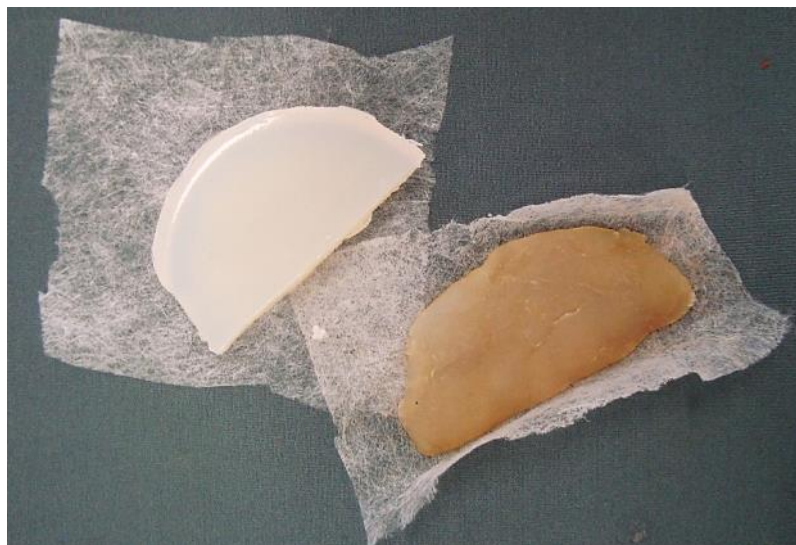
Figura 42 - Oxidação do gel rígido: antes e depois
