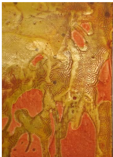
Figura 23 - Detalhe da área resinosa com enrugamento
