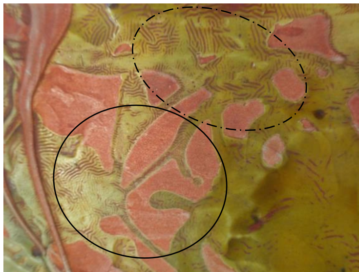
Figura 35 - Resultado do teste. Linha pontilhada área suja; linha contínua área limpa
