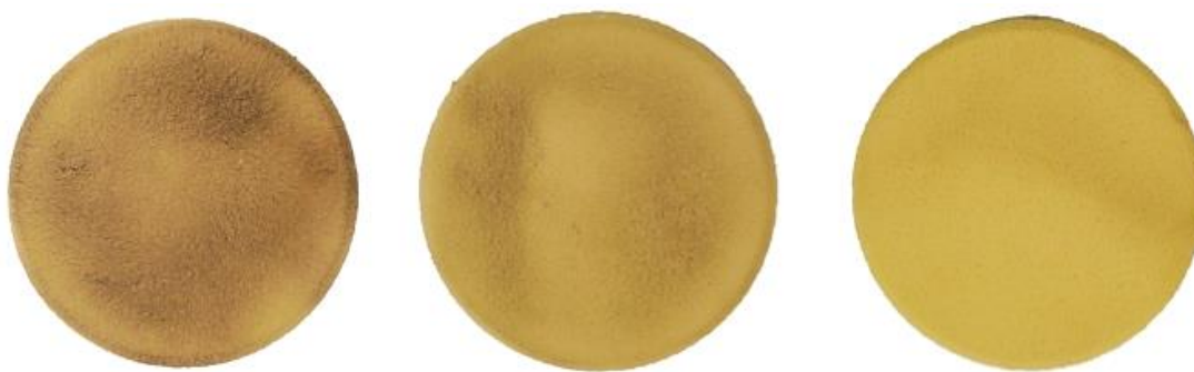
Figura 37 - Sujidades removidas pela esponja durante três aplicações
