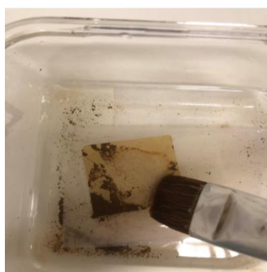
Aplicação da trincha para remoção da lama
