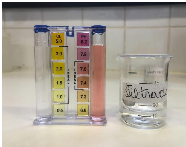
Figura 7 – Resultados da concentração de cloro e nível de pH na água filtrada.
