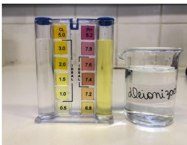
Figura 9 – Resultados da concentração de cloro e nível de pH na água deionizada.
