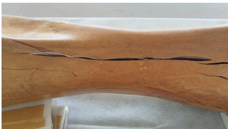
Figura 14: Junta de dilatação realizado com filme de poliéster
