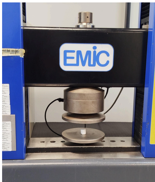
Figura 13: Prensa utilizada para o ensaio de compressão
