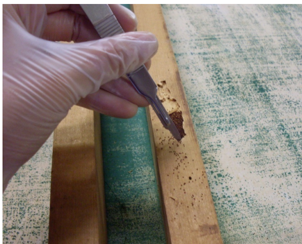
FIGURA 13 - Extensão de galerias de cupins, trava direita inferior. Foto Nelyane Santos, Novembro de 2011.
