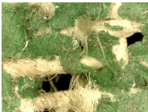
FIGURA 18: Imagem microscópica (aumento de 200 x) de área com perda de base de preparação e camada pictórica. Foto Nelyane Santos, Novembro de 2011.
