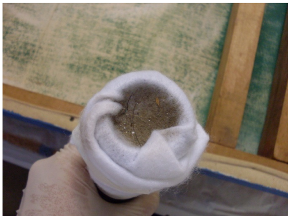
FIGURA 19 – Aspecto do feltro utilizado após a limpeza com aspirador de pó do verso. Foto Nelyane Santos, Novembro de 2011.
