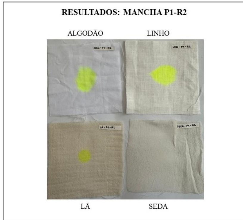
Figura 23 - Manchas nas amostras têxteis, P1-R2 (após experimentos).
