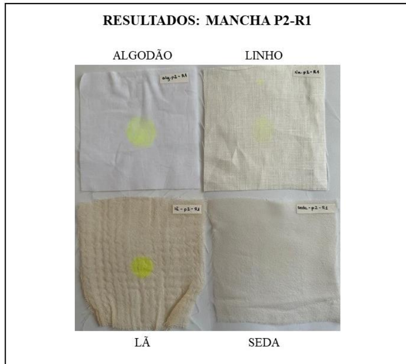
Figura 27 - Manchas nas amostras têxteis, P2-R1 (após experimentos).
