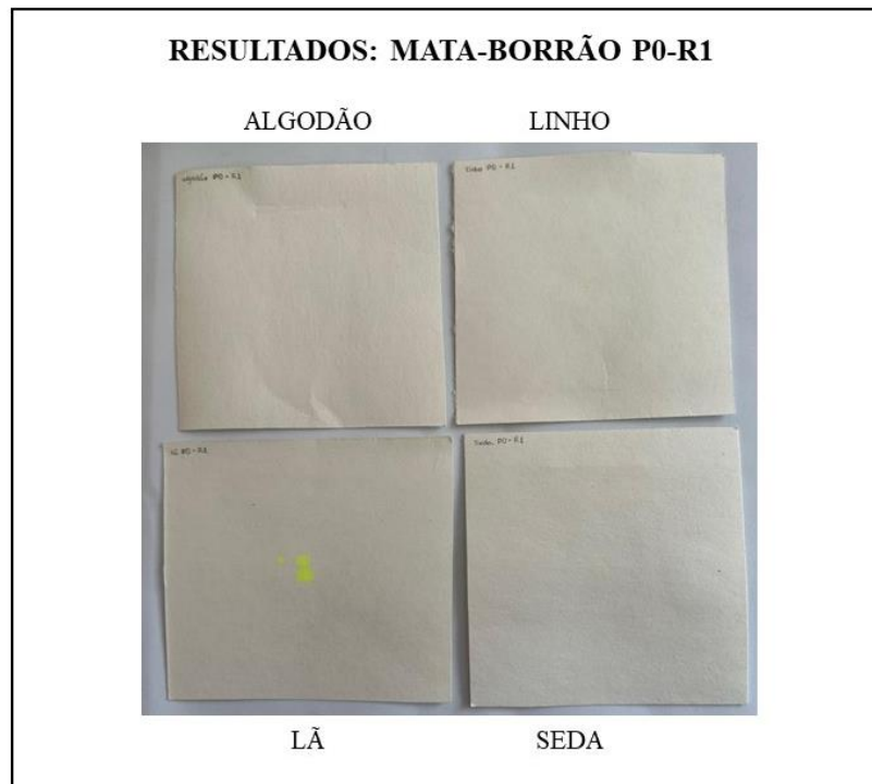
Figura 16 - Manchas nas amostras de mata-borrão, P0-R1 (após experimentos).
