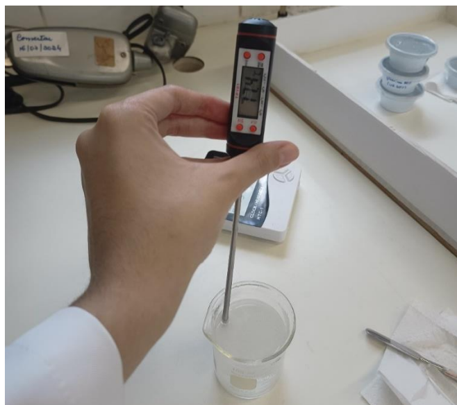
Figura 10 - Medição da temperatura do gel após aquecimento.
