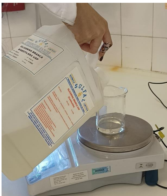
Figura 8 - Preparo mistura de glicerina e água deionizada.
