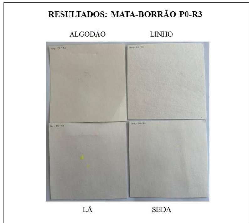
Figura 20 - Manchas nas amostras de mata-borrão, P0-R3 (após experimentos).
