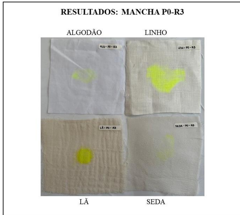
Figura 19 - Manchas nas amostras têxteis, P0-R3 (após experimentos).
