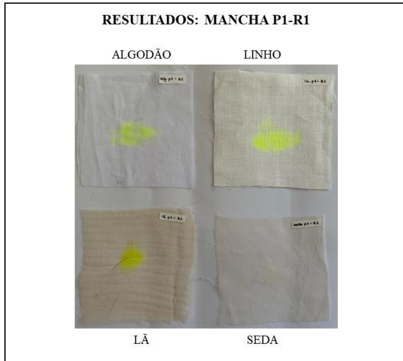
Figura 21 - Manchas nas amostras têxteis, P1-R1 (após experimentos).
