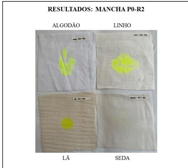
Figura 17 - Manchas nas amostras têxteis, P0-R2 (após experimentos).
