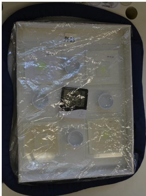
Figura 11 - Disposição do sistema após vedação com filme de poliéster e pesos.
