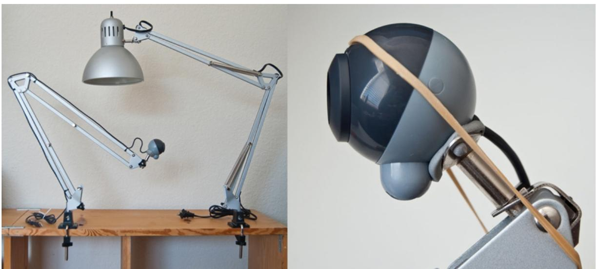
Figura 16: Exemplo de truca montada com luminária e webcam. (direita) Detalhe da webcam durante secagem. (esquerda). Fonte: site lifehacker.com
