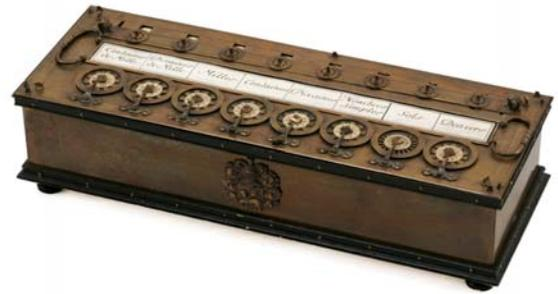
Fig2: Pascalina fechada. A máquina acima à direita podia calcular até centenas de milhares. À direita um sistema de engrenagens que giravam um cilindro com a impressão dos números.
